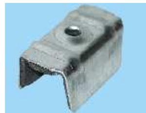
Cappello in acciaio (DX521D) zincato e verniciato, con spessore 0,6 mm.
